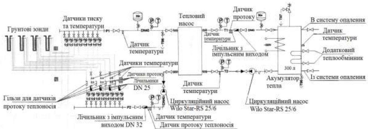
Рис. 3. Принципова схема експериментальної геотермальної теплонасосної системи, розробленої здобувачем та сконструйованої в УкрДГРІ
