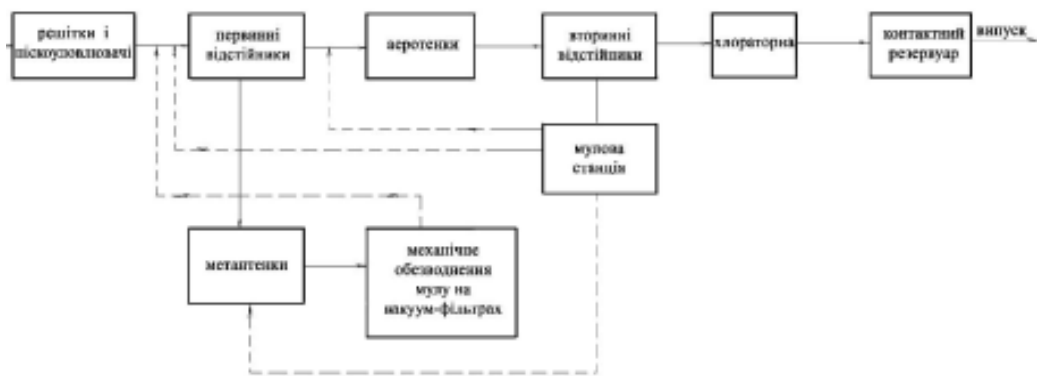
Рисунок 5.3 – Типова схема очисних споруд для біологічного очищення стічних вод
