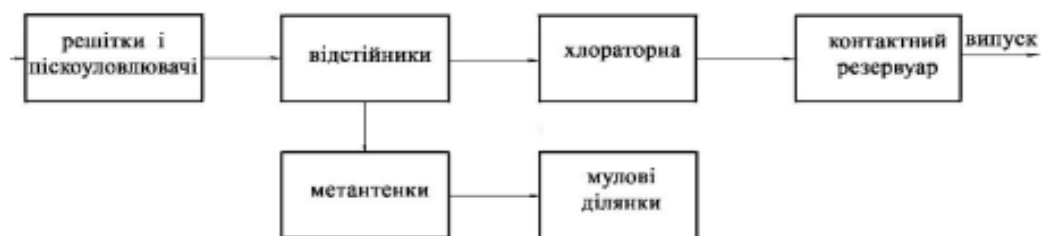
Рисунок 5.2 – Схема очисних споруд для механічного очищення стічних вод
