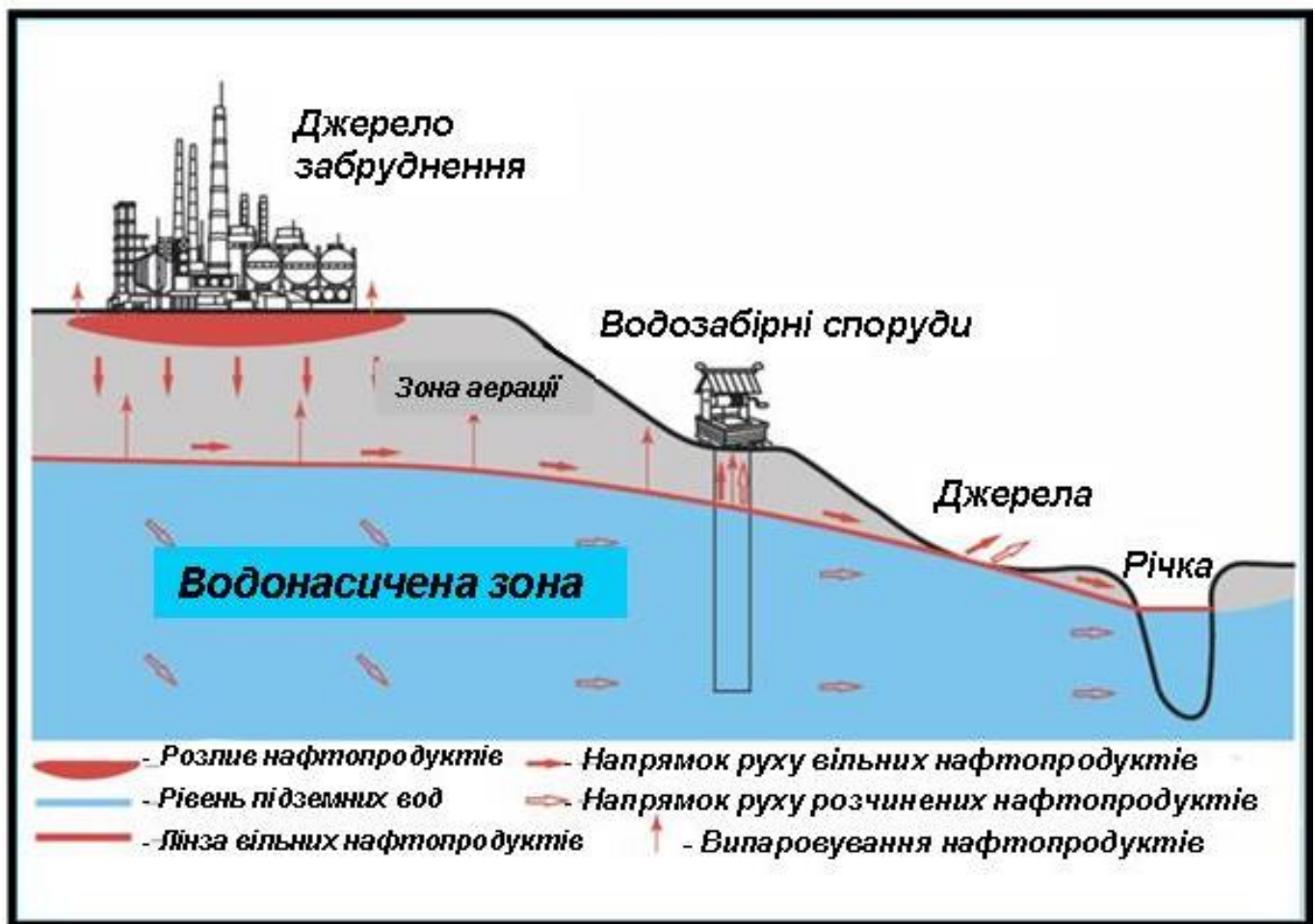
Рисунок 1.2 – Особливості формування забруднення підземних та поверхневих вод нафтопродуктами
