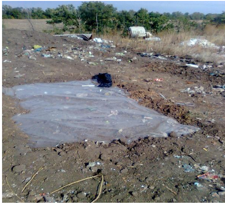
Рисунок 4.2 – Відбір проб біогазу з поверхні полігону ТПВ
